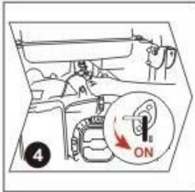
Vire a alavanca da válvula de combustível para a posição ON permitindo que o fluxo de combustível passe para o carburador.
