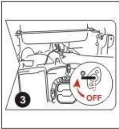
Feche a alavanca da válvula de combustível somente após desligar o motor do gerador.
