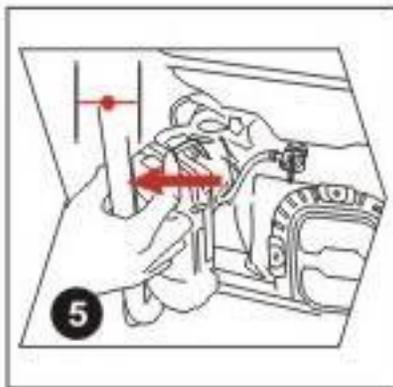
O afogador fornece uma mistura de combustível enriquecida quando o motor está frio. Quando o motor estiver frio, mover a alavanca do afogador para a posição OFF. Quando estabilizar a aceleração do motor, gradualmente mova a alavanca do afogador para a posição "ON".
