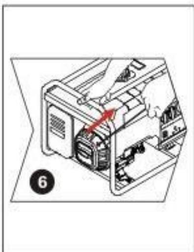
Puxe a empunhadura de partida levemente até sentir resistência, em seguida puxe rapidamente. Retorne a empunhadura levemente.
