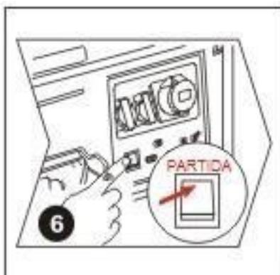
Pressione o interruptor do motor no painel de controle para ON. Não pressione o botão por mais de 3 segundos e o intervalo entre duas tentativas deve ser superior a 10 segundos.
