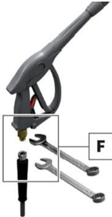
4 – Encaixar a conexão da mangueira de alta pressão no conector da pistola. Rosquear a conexão e depois apertar (conforme força moderada) com o auxílio de duas chaves de boca de 22 mm (F).
