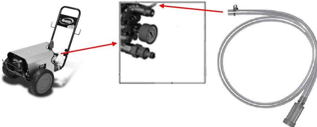
2 – Colocar a mangueira de sucção de detergente no conector de sucção detergente.
