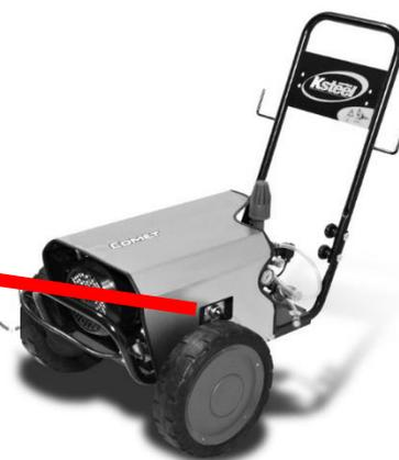
3 – Girar a chave liga/desliga até a posição desligado “0”. Conectar o plugue na tomada.
