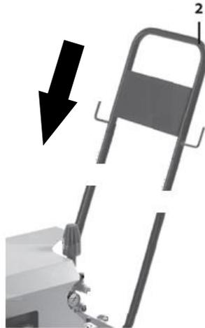
2 – Encaixar a empunhadura (2) nos tubos que saem da máquina. Apertar os parafusos para fixar a empunhadura.
