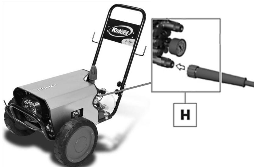
6 – Colocar o conector fêmea da mangueira de alimentação no conector de entrada da bomba (G) e rosqueá-lo com a mão até dar aperto. Não utilizar nenhum tipo de ferramenta para apertar.
