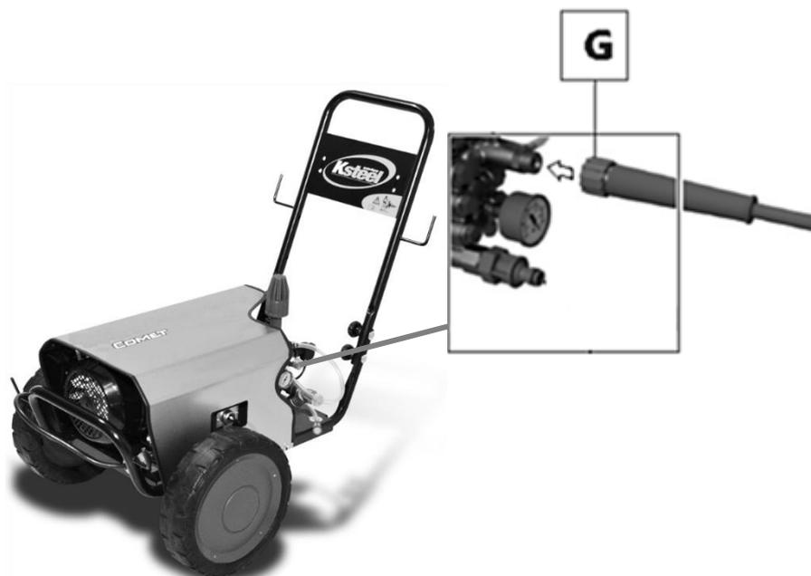
3 – Encaixar o engate rápido da mangueira de alta pressão (G) na saída da bomba e aperta-lo com a mão até dar aperto. Não utilizar nenhum tipo de ferramenta para apertar.
