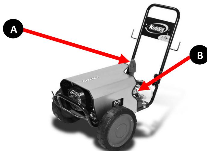
7 – Caso haja a necessidade de regular a pressão de trabalho, basta girar o botão regulador de pressão (A) no **sentido horário para aumentar** ou no **sentido anti-horário para diminuir** a pressão. Utilize o manômetro (B) para auxiliar no ajuste da pressão desejada.
