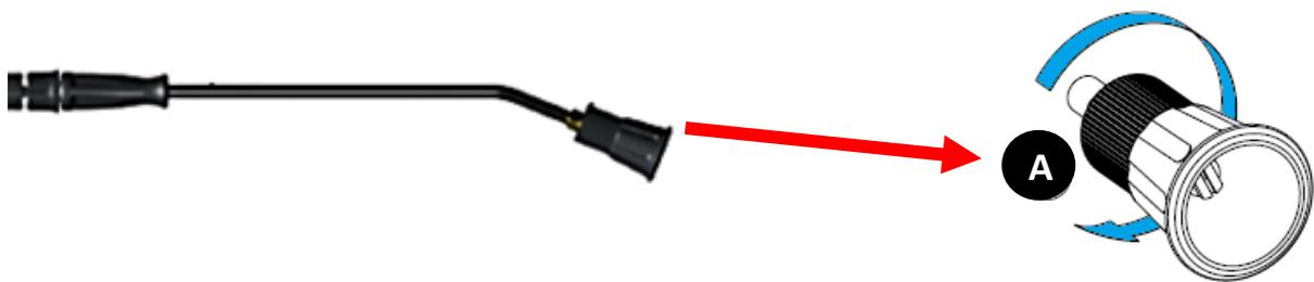
4 – Abrir o venture da lança girando a capa do bico conforme figura (A).
