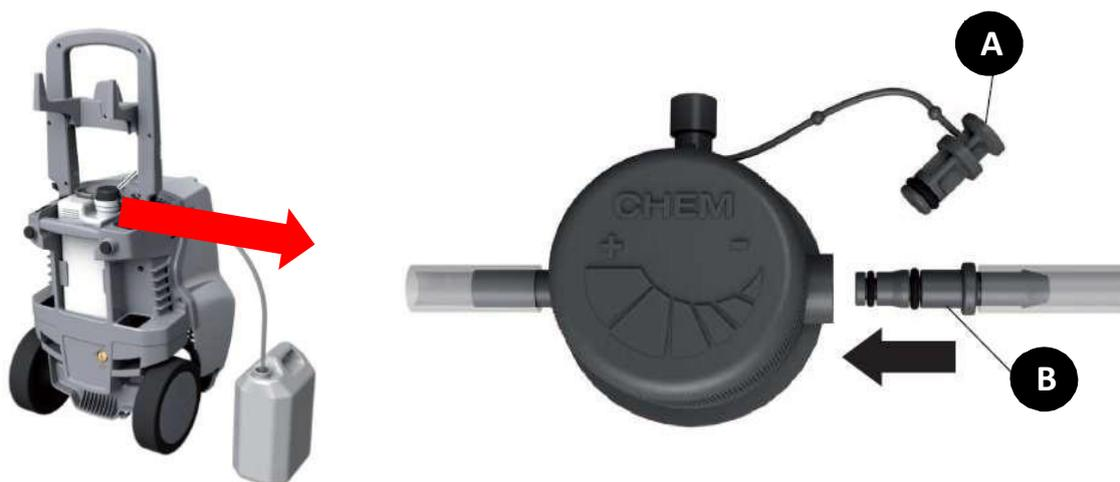
7 – Para utilização de reservatório externo, retirar o tampão (A) da tampa do tanque de detergente e introduzir o conector (B) com mangueira auxiliar.
