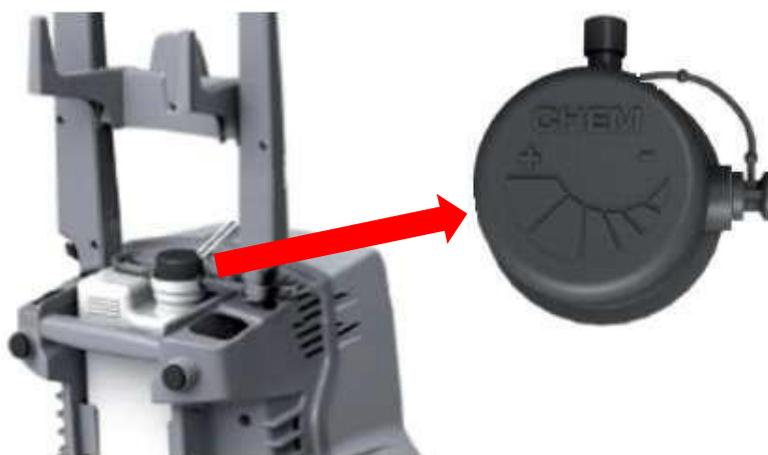
5 – Para ajustar a quantidade de detergente a ser utilizada, ajuste a vazão na tampa do tanque de detergente. Para aumentar a quantidade gire a tampa no sentido horário, para diminuir gire anti-horário.
