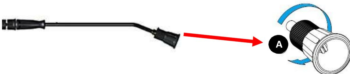
3 – Abrir o venturo da lança girando a capa do bico conforme figura (A).
