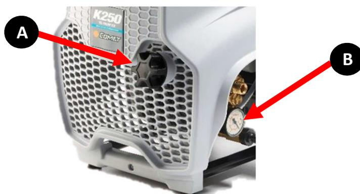
7 – Caso haja a necessidade de regular a pressão de trabalho, basta girar o botão regulador de pressão (A) no **sentido horário para aumentar** ou no **sentido anti-horário para diminuir** a pressão. Utilize o manômetro (B) para auxiliar no ajuste da pressão desejada.
