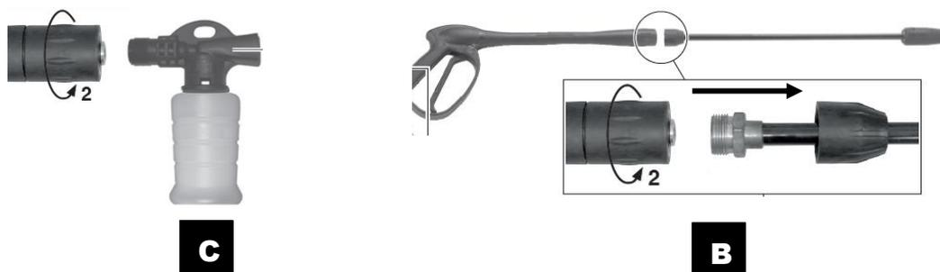
4.a – Para retornar ao modo pressão, retirar o porta detergente (C) e recolocar a lança (B) (modelo – PW 136 C)
