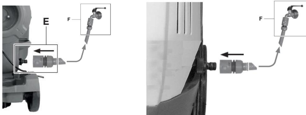
2 – Conectar a hidrolavadora a rede de água (torneira). Abrir a torneira totalmente, isso permitirá a vazão necessária para alimentar a hidrolavadora.
