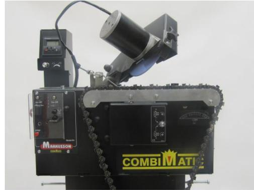
3: Vire a máquina e dê uma olhada atrás. Inicie a máquina e observe como o braço de elevação (1) encontra a flange (2).
