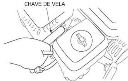
3. Inspeção a vela e substitua a mesma se os eletrodos estiverem gastos ou se o isolador estiver trincado.
