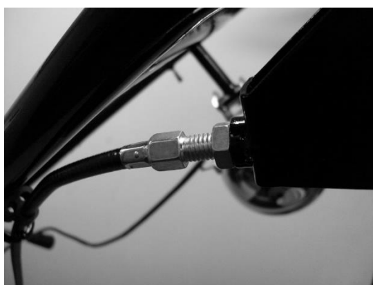
14 - Após a montagem do conjunto cabo/mola da embreagem, verificar seu curso, se necessário realizar algum ajuste, fazê-lo soltando a contra porca do parafuso de ajuste do cabo.
