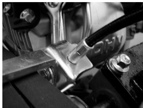
13 - Encaixar o cabo da embreagem no suporte do cabo.
