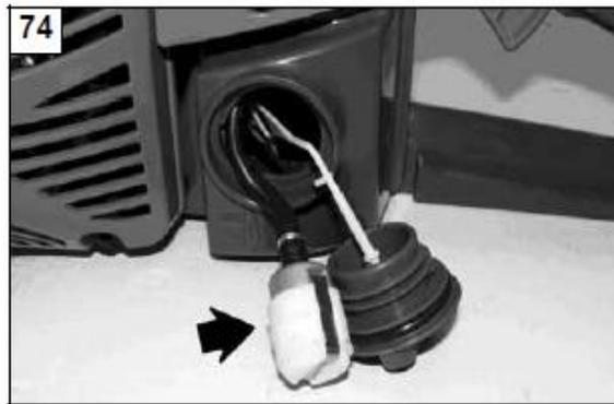
1. Retire o filtro usando um gancho de arame, através da boca do tanque. Retire ambos os elementos do filtro e lave-os bem com gasolina. Se o filtro estiver obstruído, substitua por um filtro novo (Fig. 74).
