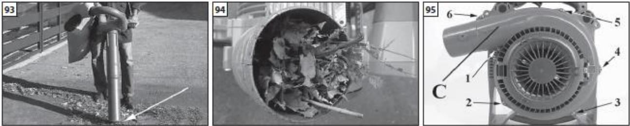
**⚠ IMPORTANTE** - Ruídos anormais ou variações de rotação do motor podem indicar entupimento do rotor. Desliga a máquina, retire o tubo de aspiração e verifique se existem resíduos no rotor e na espiral de saída (Fig.94). Se for necessário fazer uma limpeza mais profunda, solte os 6 parafusos de fixação da espiral de saída (C-Fig.95).
