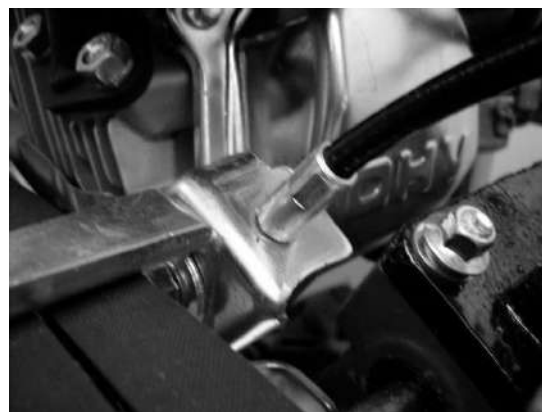
13 - Encaixar o cabo da embreagem no suporte do cabo.
