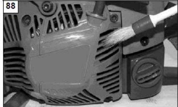
1. Aletas sujas ou empoeiradas podem causar superaquecimento no motor. Limpe entre as aletas do cilindro e as entradas de ar das aletas da caixa de partida/ventilação (Fig. 88). Caso as aletas do cilindro estejam severamente obstruídas, a limpeza deve ser efetuada após a remoção da tampa da partida (Fig. 76).
